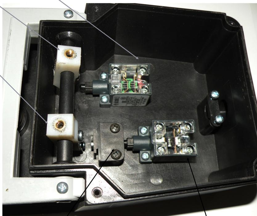
Dispositivo meccanico per il rilascio dei contatti di partenza durante la 3 posizione, in questo modo i contatti di avvio rimangono inibiti sino al ritorno completo della pedalina (azionatore a piede)
